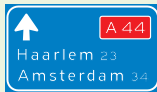
K1 Lage beslissingswegwijzer langs autosnelweg voor de doorgaande richting, met interlokale doelen en route- nummer autosnelweg
