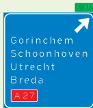
K4 Hoge beslissingswegwijzer langs autosnelweg met rijstrook- paneel voor de doorgaande richting en aftakingspaneel voor de afgaande richting, met interlokale doelen, route- nummers autosnelwegen en Europese hoofdroutes
