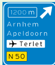
K2 Voorwegwijzer langs autosnelweg voor de afgaande richting, met afstandaanduiding, in- terlokale doelen (bo- venste doel=afritnaam) verwijzing naar vlieg- veld/ luchthaven en routennummer niet-au- tosnelweg
